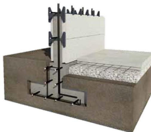
Anclaje a cimentación según proyecto
